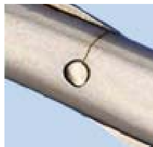
Schlussgelenk Schere mit typischem interkristallinem Anriss.
