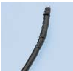
Aufquellung am Distalende eines Fiberskops.
