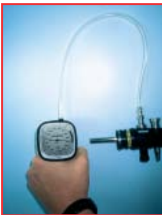
Provjera fleksibilnog endoskopa na propuštanje
