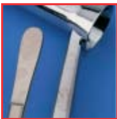
Mrlje uzrokovane visokom razinom soli u vodi za ispiranje
