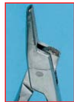
Slomljeni krak metalnog iglo-držača
