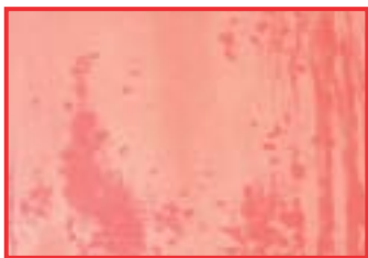
Optičke promjene na u boji anodiziranom aluminiju se javljaju čak i kada su pod utjecajem blago lužnatih otopina.
