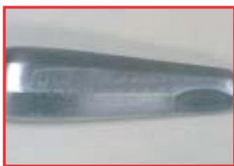
Zaostalo sredstvo za čišćenje zbog nedovoljnog ispiranja
