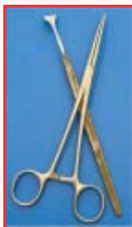
Kontaktna korozija među predmetima od nehrđajućeg čelika i mjedi
