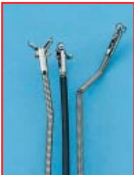
Hvataljke za biopsiju oštećene savijanjem - lomljenjem
