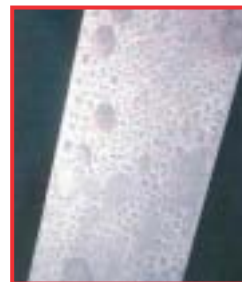
Površina instrumenta sa kapljicastom promjenom boje
