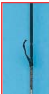
Oštećena izolacija na elektrokirurškom instrumentu
