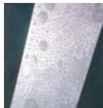
permukaan instrumen dengan perubahan warna berbintik-bintik
