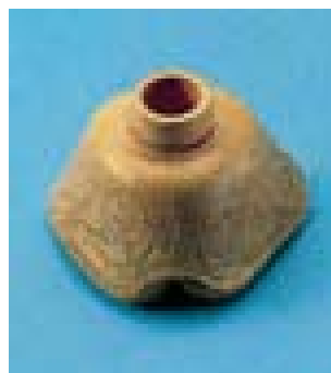
Retakan pada masker pernafasan karena penuaan
