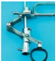
Kerusakan hanya pada komponen aluminium Penyebab: penggunaan deterjen tinggi alkali
