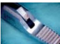
Patah pada rahang klem
