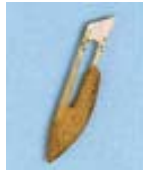
Formasi karat pada pisau bedah Penyebab: bukan baja stainless; produk disposable
