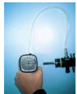
Test kebocoran secara manual pada fleksibel endoskopi
