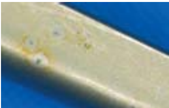
Pitting pada instrumen yang disebabkan oleh Khlorida
