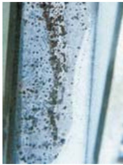
Deposit pada instrumen akibat dari substansi yang mengandung Khlorida
