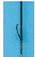
Kerusakan isolasi pada instrumen HF
