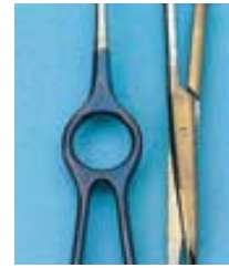
Perubahan warna instrumen oleh asam salisilat
