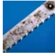
Formasi karat pada lapisan kromium tampak pada pisau berbahan baja karbon Penyebab: kerusakan pada lapisan kromium
