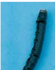
Pemuaihan pada ujung distal fiberscope
