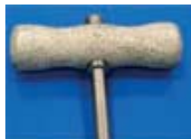
Kerusakan hanya pada pegangan aluminium Penyebab: Penggunaan deterjen tinggi alkalin
