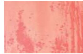
Perubahan secara optikal pada warna aluminium anodized, walaupun dalam larutan berkadar alkalin menengah.
