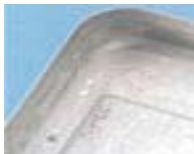
Serangan pada material Penyebab: Pembersih alkalin
