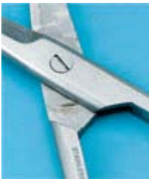
Korosi akibat gesekan karena kurangnya pelumasan
