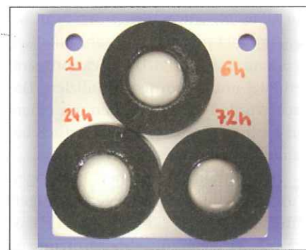
Abb. 1: Anordnung der Messzellen auf dem Prüfkörper
