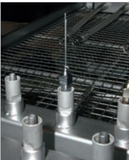
Abb. 5: Injektionskanüle-Kanüle, doppelläufig für flüssige Perfluorocarbone, 24 Gauge/0.55 mm seitl. Rohr: 25 Gauge/0.5 mm
