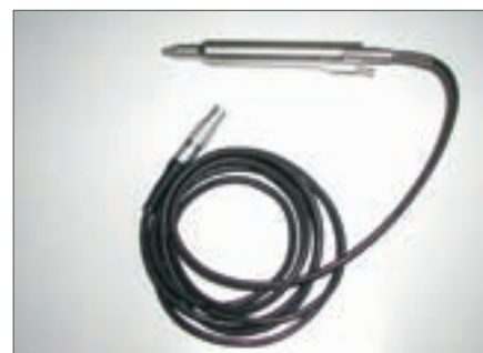
Abb. 11: Piezokeramischer Ultraschallhandgriff P2 (Phakohandgriff) Durchmesser 14,5 mm, Länge 125 mm
