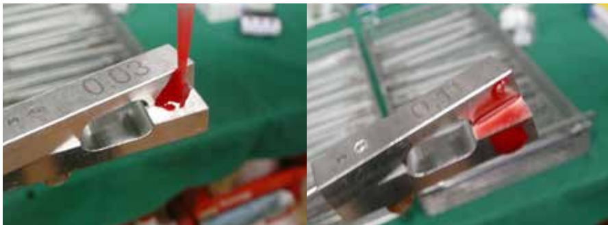
Abb. 2: Kontamination Prüfkörper: Pipettieren auf die Fläche und Bewegen
