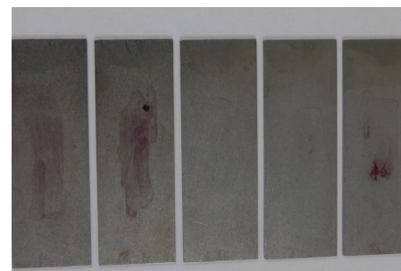
Fig. 2: 1 Minuto en baño ultrasonido de los objetos de prueba tratados con sangre bovina secada coagulada tras tinción con Ponceau S.
