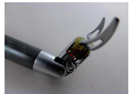
Abb. 2: Sichtbarer Blutrückstand bei Maryland Bipolar Forceps des Testlauf 2
